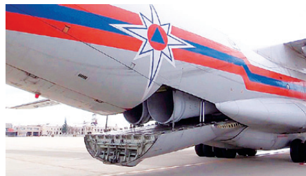
Самолет Ил-76ТД в противопожарном варианте. Выливной авиационный прибор ВАП-2
