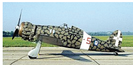
Макки C.200 «Саетта» (итал. Macchi C.200 Saetta , «Молния») – одноместный итальянский истребитель Второй мировой войны
