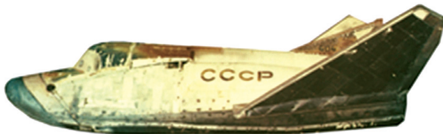
Первый отечественный орбитальный воздушно-космический аппарат «Бор-4» (беспилотный орбитальный ракетоплан) после летных испытаний
