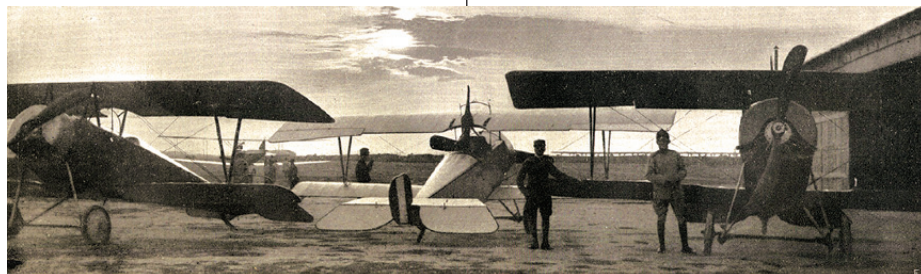
Ньюпор 17 (Nieuport 17) – базовая модель французского истребителя Первой мировой войны, выполненного по схеме полумотораплана.
