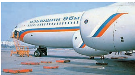
Установка двигателей PW-2337 под крылом Ил-96МО. (Перед запуском двигателей на полосу уложили стальные листы для защиты вздухозаборников от попадания посторонних предметов)
