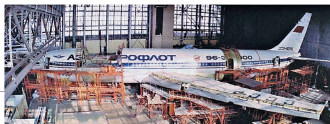
Доработка Ил-96-300 при создании самолета Ил-96МО
