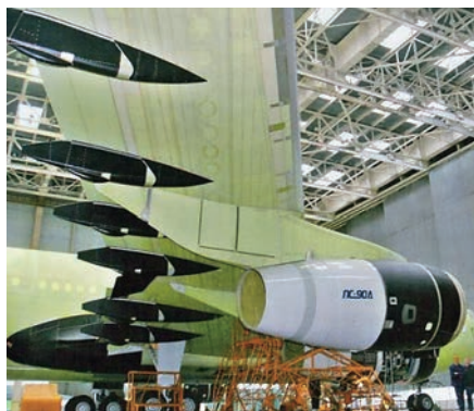
Композиционные материалы (углепластиковая обшивка – черного цвета) в конструкции Ил-96-300
