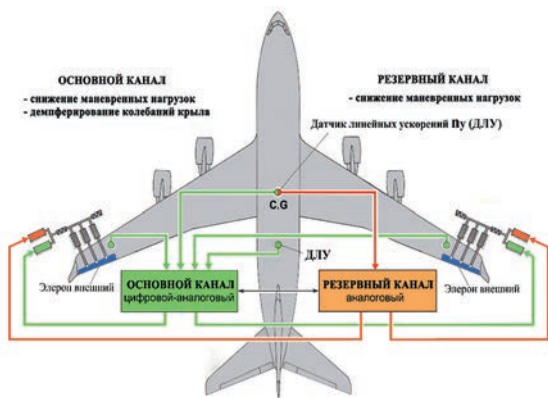
Структурная схема системы активного демпфирования упругих колебаний крыла Ил-96-300
