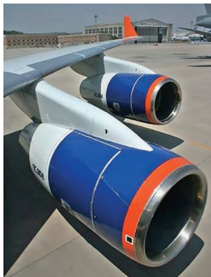
Мотогондолы с двигателями ПС-90А на крыле Ил-96-300
