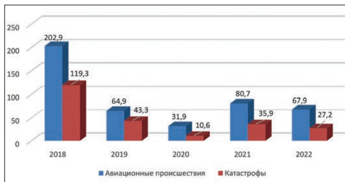
Рис. 5. Количество авиационных происшествий и катастроф на 1 млн вылетов с вертолетами в гражданской авиации государств-участников Соглашения без АОН
