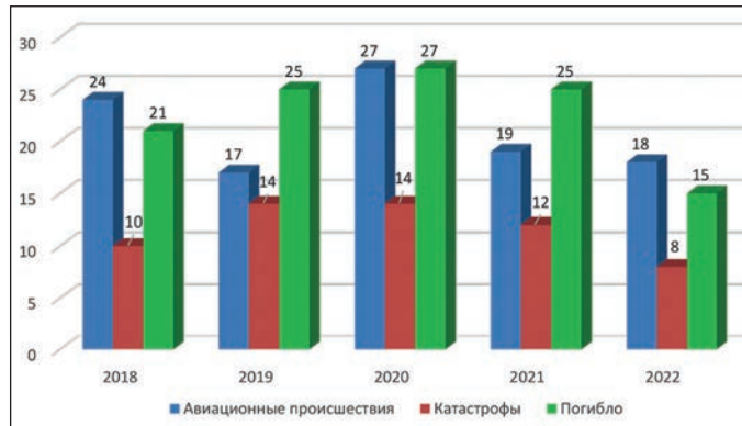
Рис. 6. Абсолютное количество авиационных происшествий и катастроф с воздушными судами АОН в гражданской авиации государств-участников Соглашения
