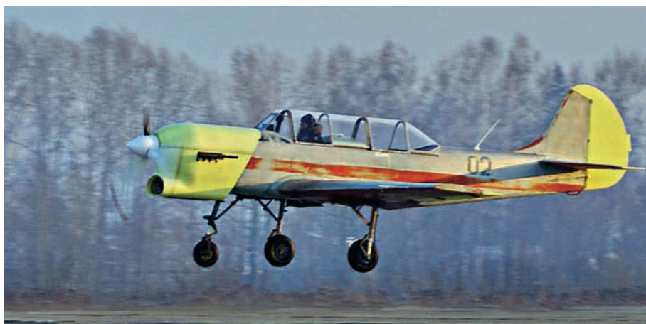
Начало летных испытаний двигателя-демонстратора АПД-А в составе летающей лаборатории на базе самолета Як-52, 2022 г.
