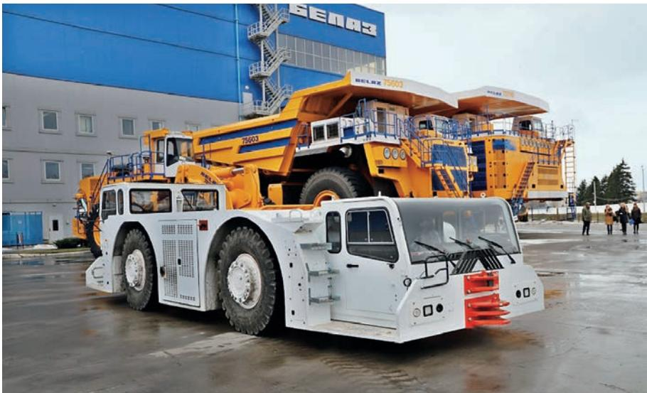
Управлять аэродромником также легко, как и легковой машиной. Переработанная система рулевого управления теперь позволяет выбрать оператору оптимальный режим поворота: поворот только передними колесами, поворот только задними колесами, синхронный поворот передними и задними колесами, поворот «крабом». В системе
