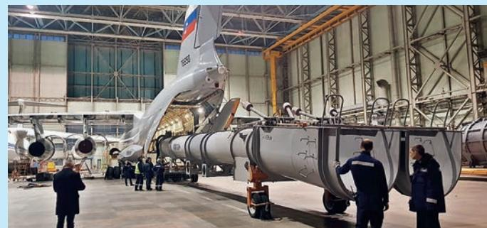
грузовой кабине самолета танкерную систему, заполненную огнегасящей жидкостью (водой или реагентом).
