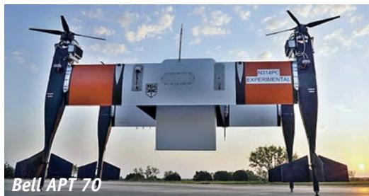
16 октября 2019 г. состоялся первый полет аппарата Autonomous Pod Transport (APT) 70 с полезной нагрузкой 27,2 кг., который взлетел вертикально, перешел в горизонтальный полет «по-самолетному», достиг скорости более 110 км/ч, прошел контрольные точки, перешел к зависанию и выполнил вертикальную посадку.
