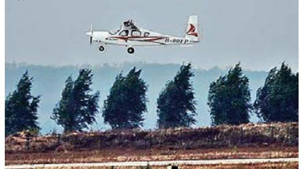
Композитный материал из углеродного волокна делает самолет очень легким. RX4E может совершить взлет на пастищах и гравийных дорогах, применяться в ряде областей, таких как транспортировка на короткие расстояния, подготовка пилотов, осмотр достопримечательностей, аэрофотосъемка и аэрокартографирование.
