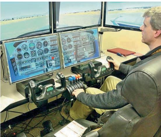
**Рис. 11. Тренажер, используемый для развития навыков взаимодействия студентов-пилотов как членов экипажа многодвигательного самолета**
