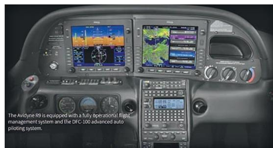
Рис. 9. Органы автоматизированного управления параметрами траектории полета и их индикации в кабине самолета Cirrus SR20
