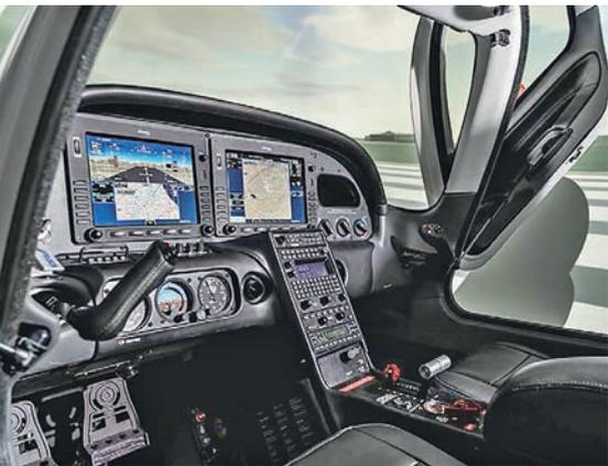
**Рис. 10. Кабина тренажера высокоавтоматизированного однодвигательного самолета Cirrus SR20**
