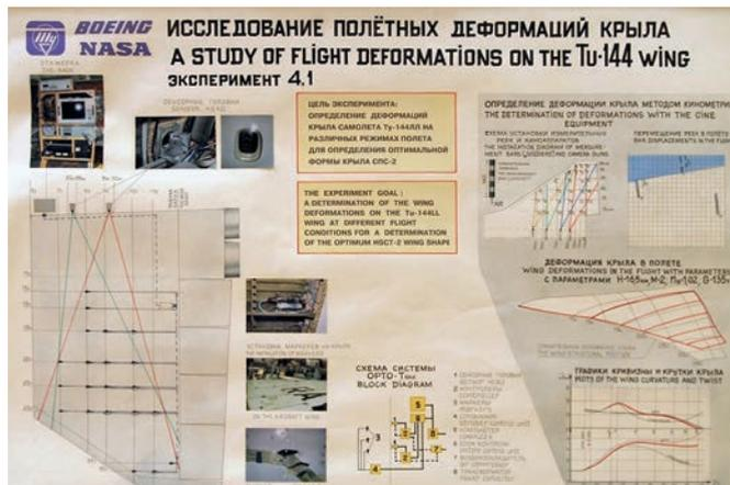
Измерение упругих деформаций крыла на летающей лаборатории Ту-144ЛЛ
