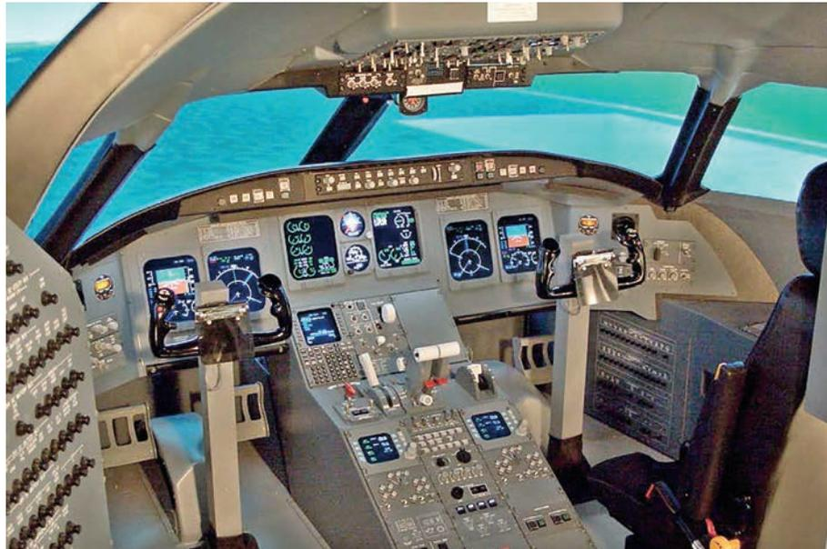
**Рис. 12. Тренажер высокоавтоматизированного регионального самолета CRJ-200 с ГТД**
